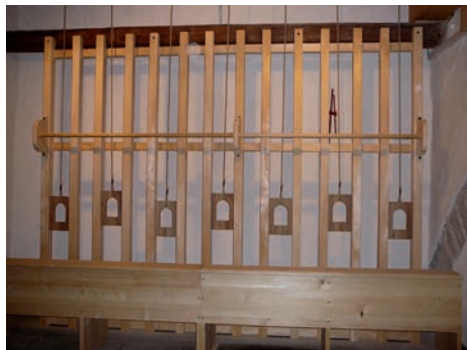
Balganlage der Hauptorgel
